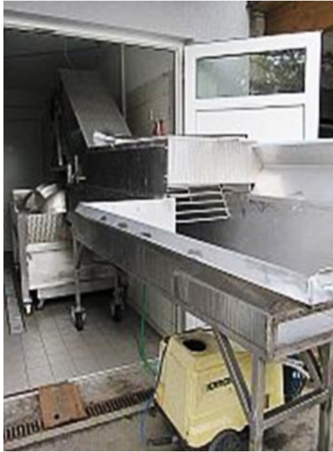
Slika: Stroj za čiščenje in prebiranje sadja s tračnim transporterjem
