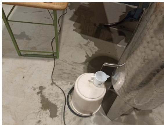
Slika: ločevanje različnih frakcij odstranjevanje metilnega alkohola
