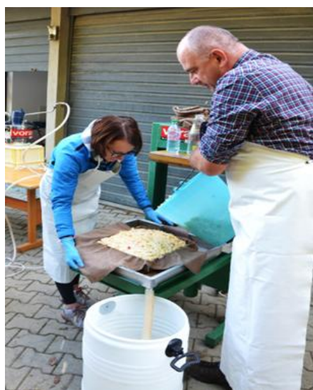
Slika: Prikaz stiskanja zmletih jabolk s pomočjo slojne stiskalnice
